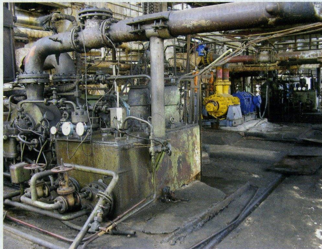
Рис. 2. На установке «Дуосол-22»: на переднем и заднем планах насосные агрегаты Н 500-500сг; между ними – АНМсг 450-500
