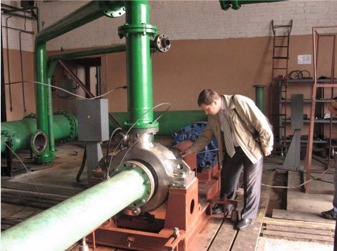
*Приемо-сдаточные испытания насосного агрегата АНКВ 225-120-Г У2
