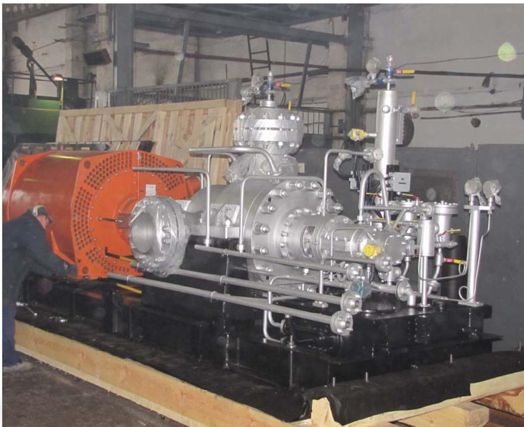
*Насосный агрегат АНДМг 600-320 со встроенной в раму маслосистемой (№=630 кВт)
