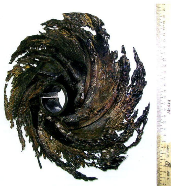
Рисунок 6. Рабочее колесо насоса НК 200/120–120 через 14 суток работы.
